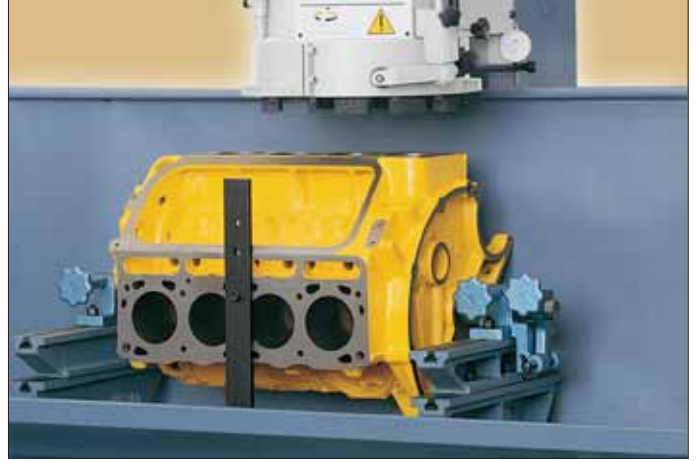
Fig. 8 Dispositivo elettronico controllo superfici e posizionamento automatico fresa (solo vers. automatica) Electronic surface control device and automatic milling cutter positioning system (automatic version only)
